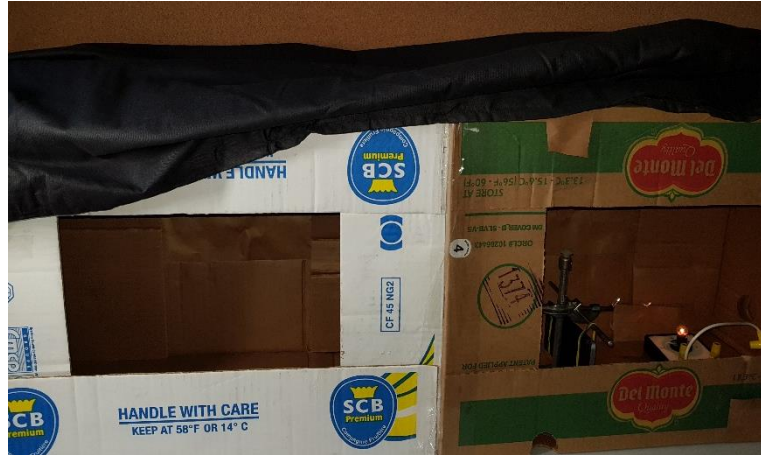
Obr. 1 : Provizórna zatemnená miestnosť na meranie osvetlenia
