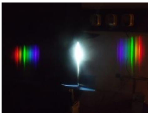
Obr. 12 Pozorujeme spektrum svetla žiarivky – studené denné svetlo pomocou mriežky z CD
