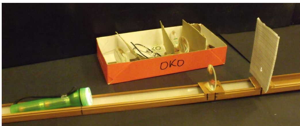
Obr. 8 Model oka, rôzne šošovky, slúžia na modelovanie zaoštrovania zmenou optickej mohutnosti oka
