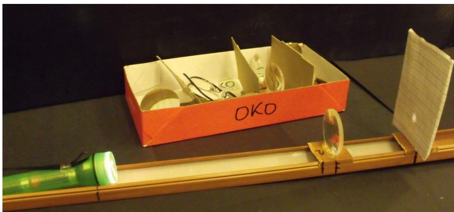
Obr. 9 Model ďalekozrakého oka, obraz je rozostrený. Posunutím tienidla by sme mohli demonštrovať, že obraz vzniká za sietnicou.
