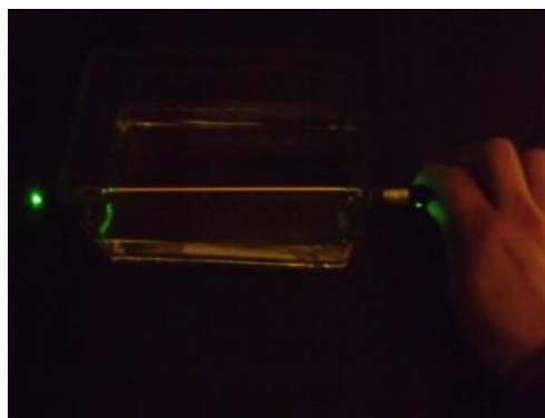
Obr. 14 Svietime zeleným laserom do oleja stopa zeleného lasera je oranžová
