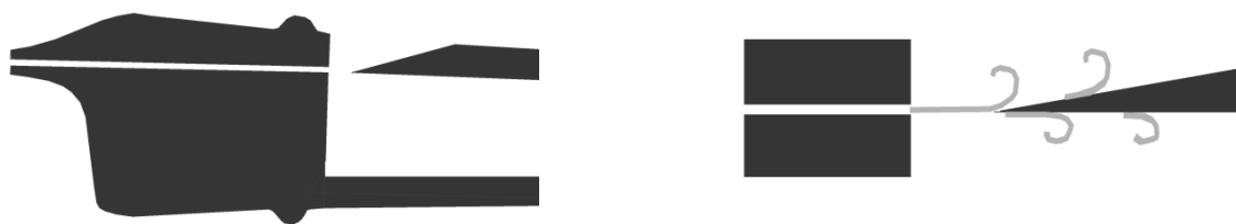
Obr. 3 Vľavo: rez hlásničkou zobcovej flauty. Vpravo: kanálikom fúkame prúd vzduchu na ostrú hranu za vzniku vírov.
