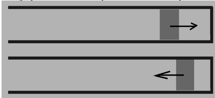
Obr. 1 Odraz tlakovej vlny na uzavretom konci trubice
