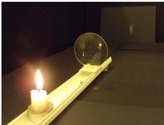
Obr. 1 Optická lavica so sviečkou a šošovkou, obraz sviečky znázornený na tienidle
