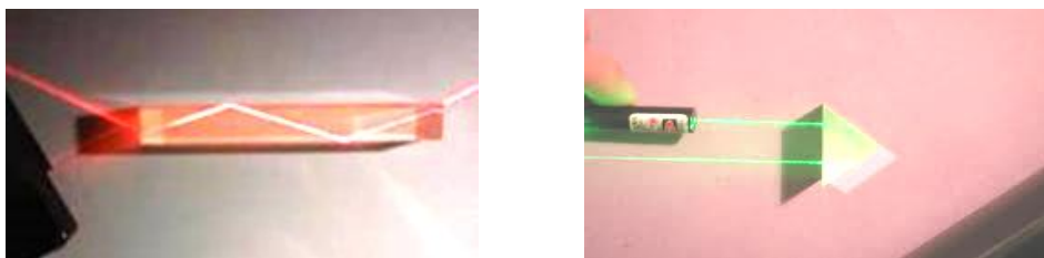
Obr. 5 Šírenie svetla totálnym odrazom
