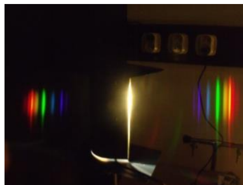
Obr. 11 Pozorujeme spektrum svetla žiarivky – teplé svetlo pomocou mriežky z CD
