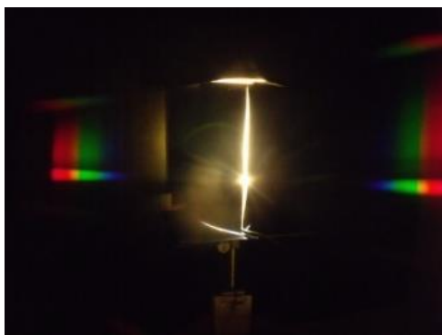
Obr. 10 Pozorujeme spektrum svetla pomocou mriežky z CD. Žiarovka je prekrytá tienidlom so štrbinou.
