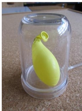
Obr. 2 Zaviazaný balón so vzduchom pod zvonom vývevy
