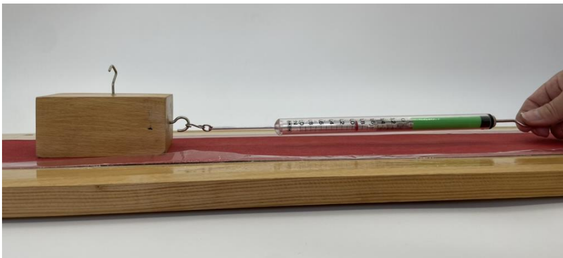
Obr. 10.3 Meranie trecej sily tesne pred pohybom a v priebehu pohybu kvádra po podložke
