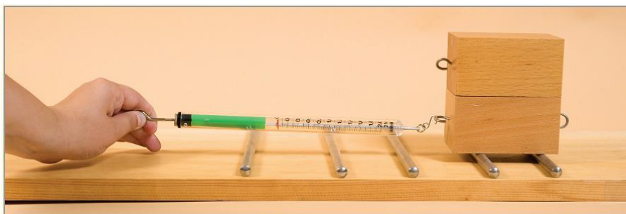
Obr. 10.6 Meranie trecej sily pri pohybe kvádrov na kovových tyčiach
