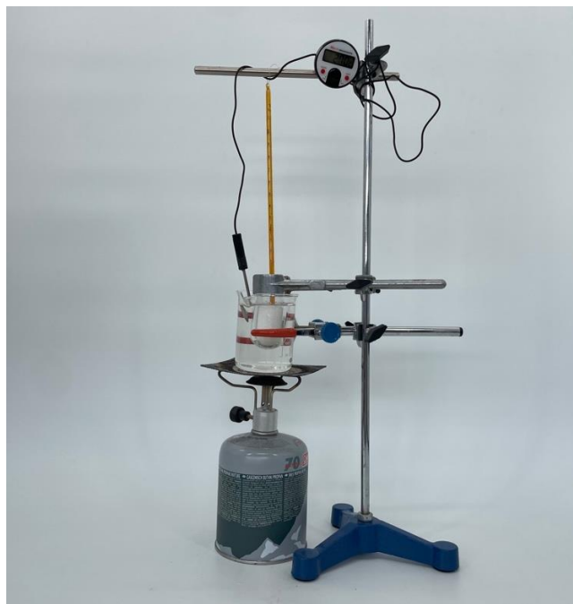
Obr. 3.18 Aparatúra na meranie teploty topenia tiosíranu sodného
