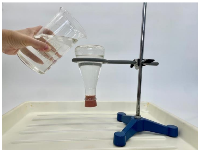
Obr. 3.10 Postup pri demonštrácii varu vody za zníženého tlaku
