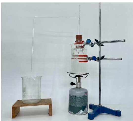
Obr. 3.12 Aparatúra na zohrievanie zmesi liehu a vody
