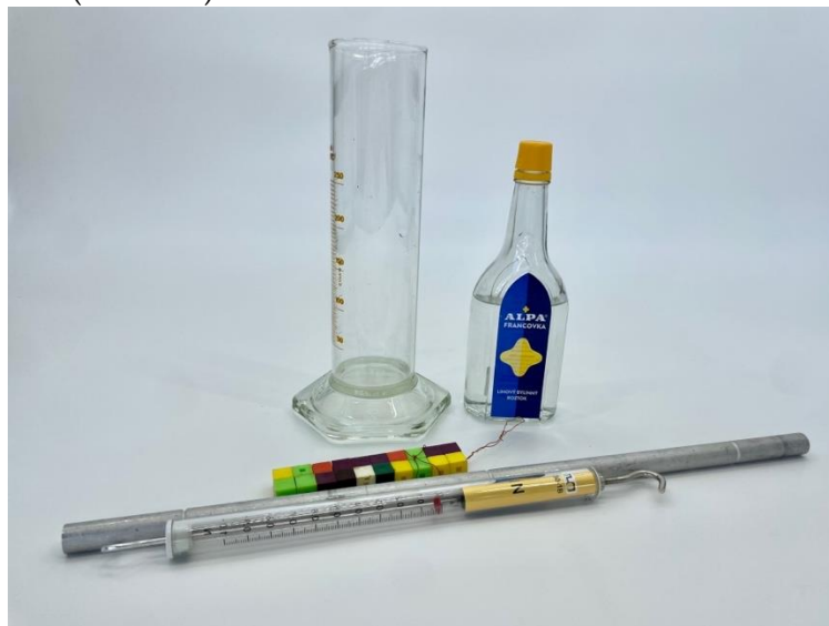
Obr. 2.15 Pomôcky na skúmanie závislosti medzi objemom ponorenej časti telesa a silou, ktorou na teleso pôsobí voda
