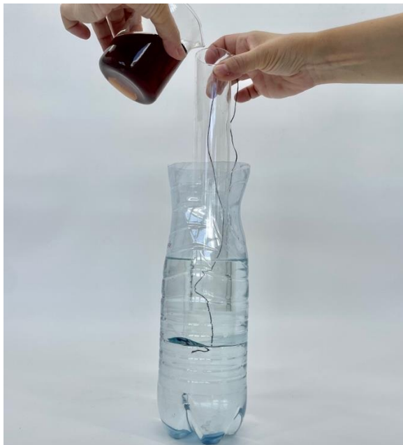
Obr. 2.19 Postup pri zisťovaní hydrostatickej tlakovej sily
