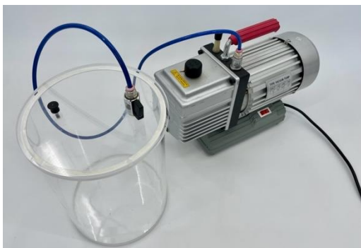
Obr. 2.21 Olejová rotačná výveva s recipientom
