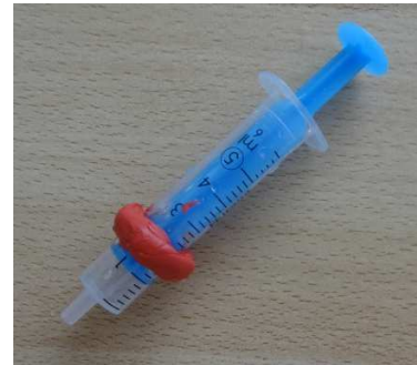
Obr.2.1.2 Príprava potápača (plastelína)
