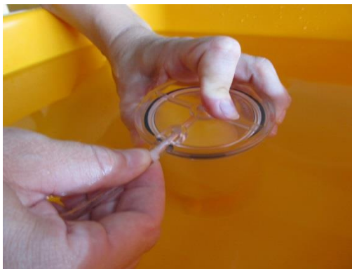
Obr. 2 Nasávanie vody do zvona vývevy
