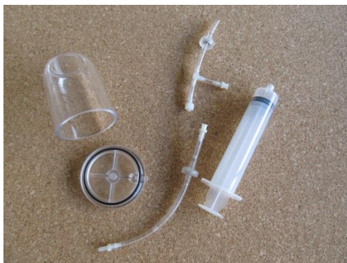
Obr. 1 Žiacka vákuová súprava – zvon, hadičky s jednocestnými ventilmi, striekačka
