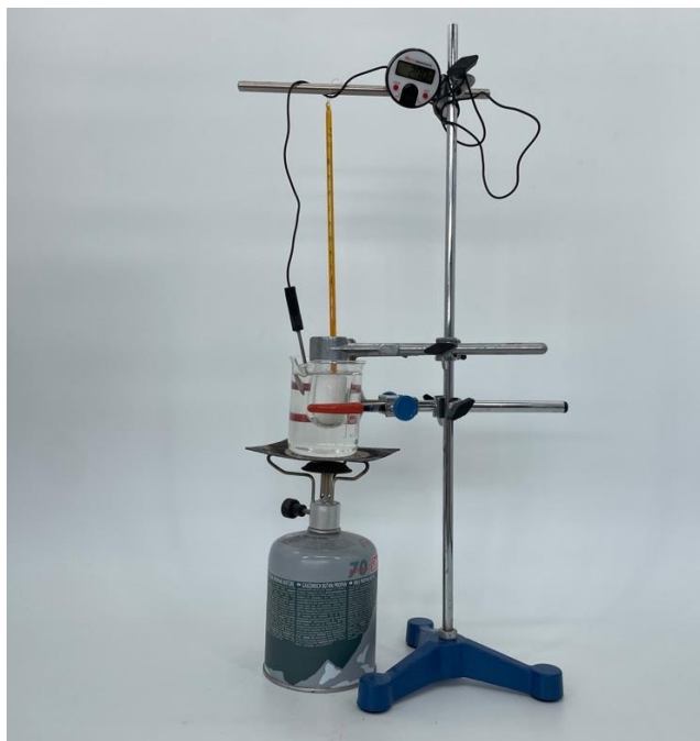
Obr. 3.18 Aparatúra na meranie teploty topenia tiosíranu sodného
