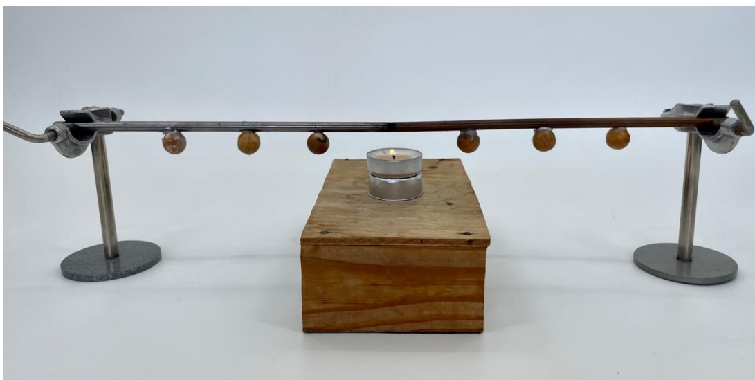
Obr. 4.8 Aparatúra na demonštráciu rôznej tepelnej vodivosti kovov
