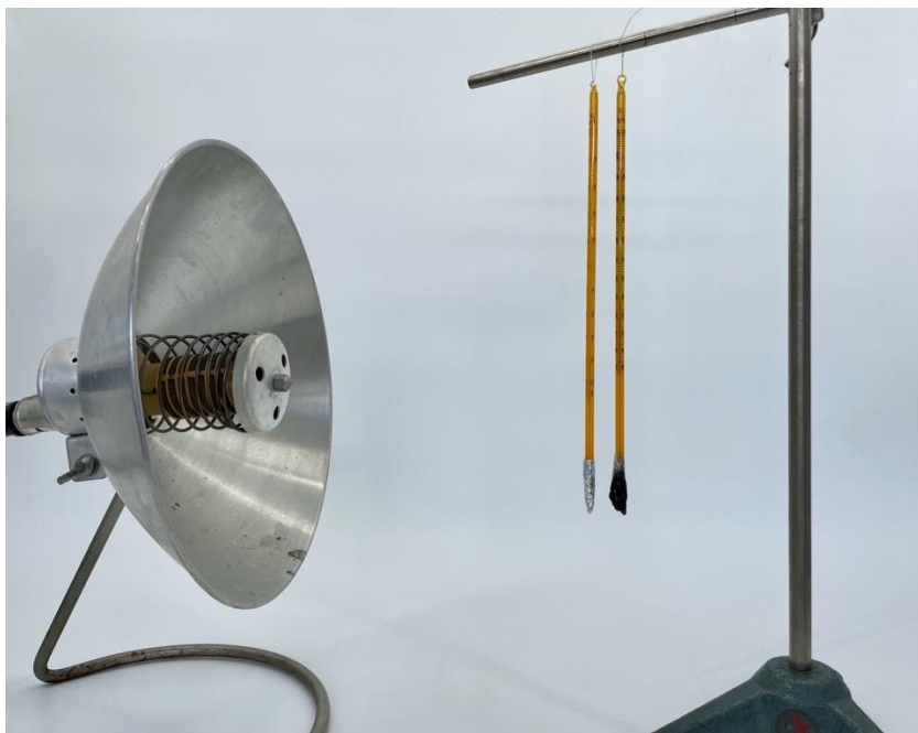
Obr. 4.11 Zisťovanie závislosti teploty od materiálu, ktorým je obalený teplomer
