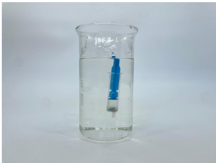
Obr. 2.2 Vyskúšanie potápača pred vloženíím do fľaše
