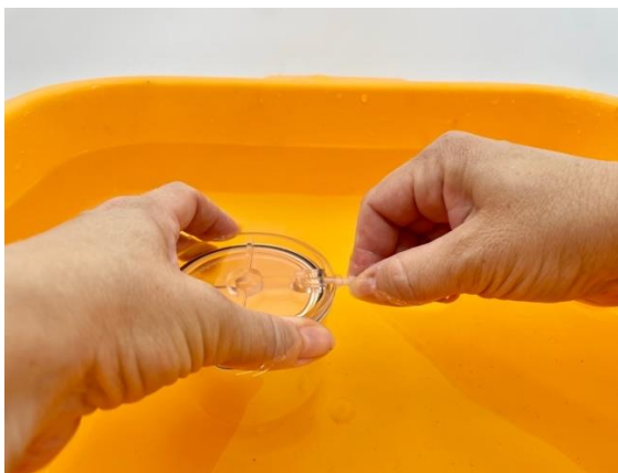
Obr. 1.23 Nasávanie vody do zvona vývevy
