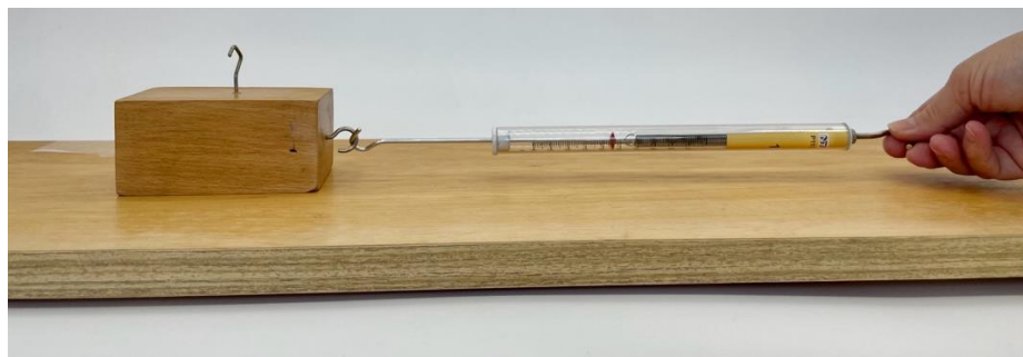
Obr. 10.4 Ťahanie kvádrov silomerom
