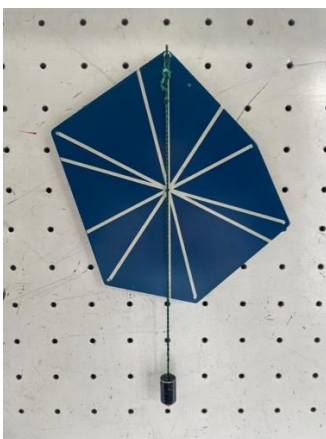
Obr. 7.3 Určovanie ťažiska nesúmerných telies
