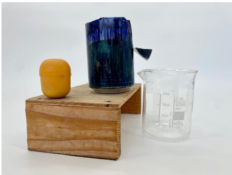
Obr. 2.10 Zostavenie pomôcok pri meraní objemu kvapaliny vytlačenej telesom
