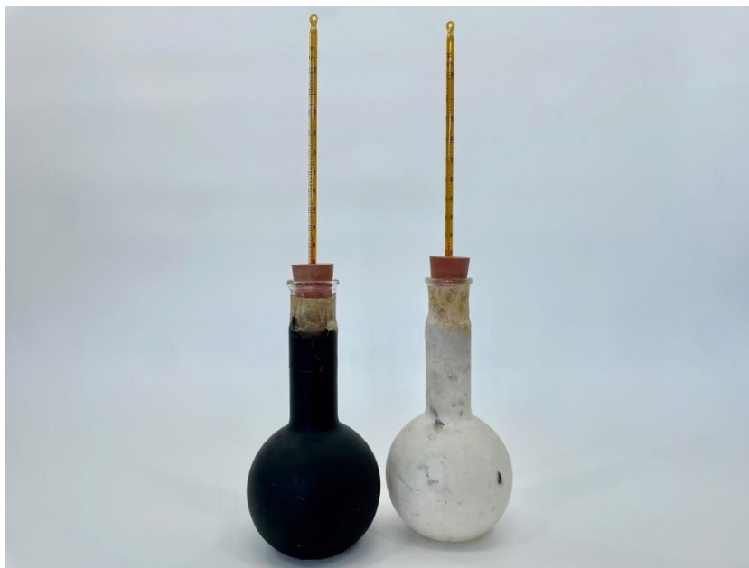
Obr. 4.12 Zisťovanie teploty vody v závislosti od povrchu banky
