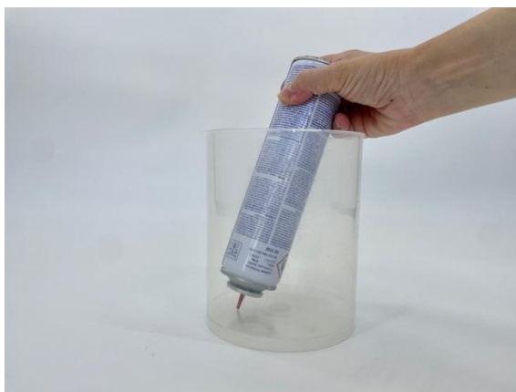
Obr. 2.14 Plnenie sklenej nádoby plynom
