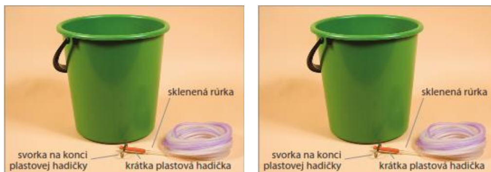
Obr. 2.16 Pomôcky na meranie atmosférického tlaku pomocou vodného stĺpca
