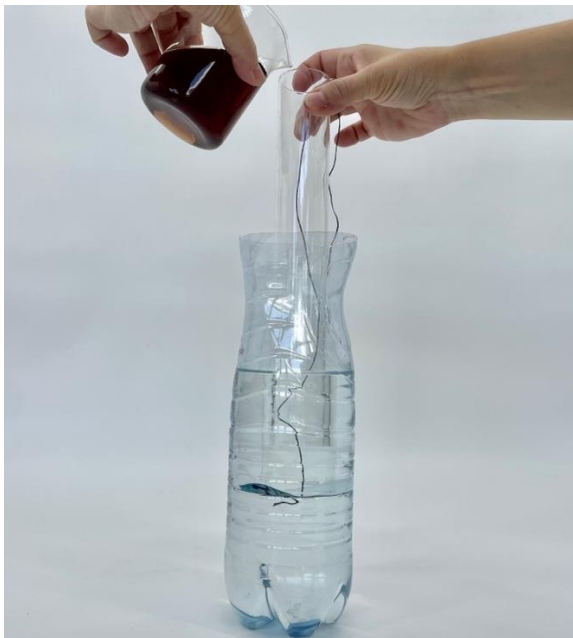
Obr. 2.19 Postup pri zisťovaní hydrostatickej tlakovej sily
