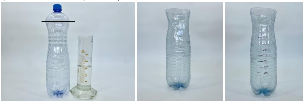
Obr. 1.9 Schematický postup pri zostrojení odmerného valca
