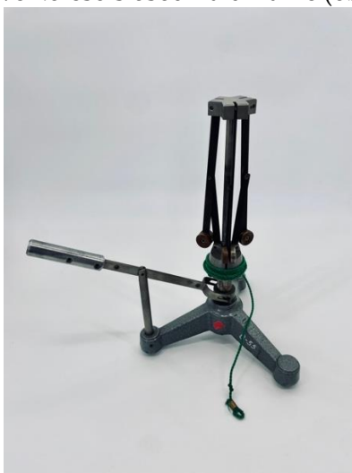
Obr. 7.7 Pomôcka na demonštráciu zákona zachovania momentu hybnosti
