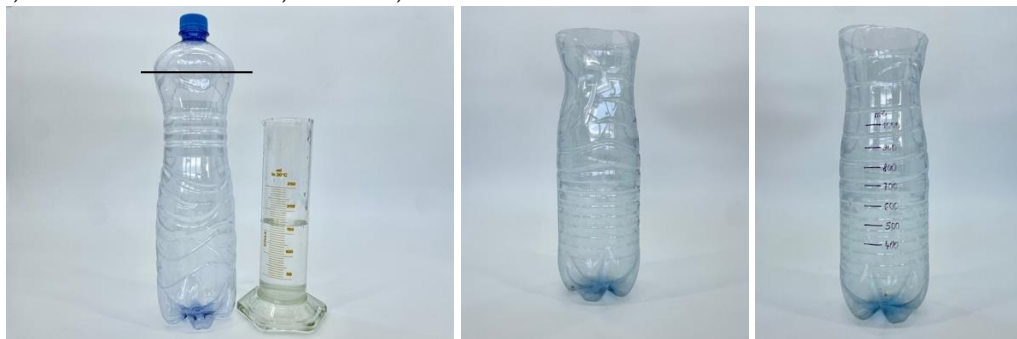
Obr. 1.9 Schematický postup pri zostrojení odmerného valca
