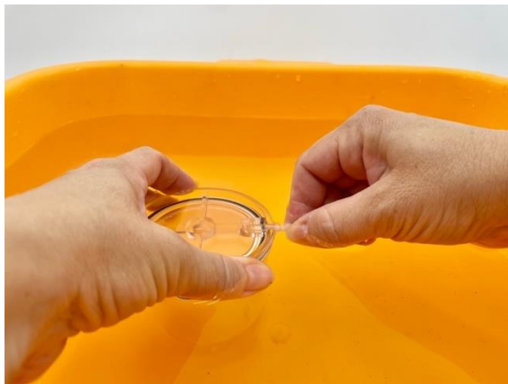
Obr. 1.23 Nasávanie vody do zvona vývevy
