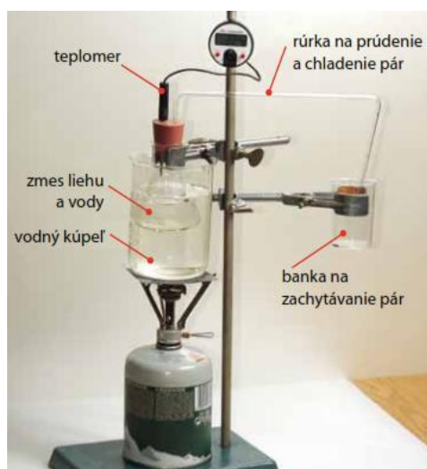
Obr. 3.1.2 Aparatúra na oddeľovanie zložiek zmesi liehu a vody (Lapitková et al., 2010, s. 35)
