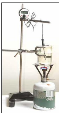
Obr. 2.2.1 Aparatúra na pozorovanie zohrievania a varu vody (Lapitková et al., 2010, s. 20)
