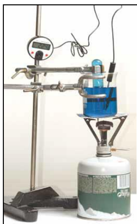
Obr. 2.2.2 Zohrievanie vody a meranie teploty
