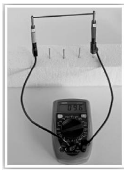
Obr. 4.2 Meranie odporu tuhy (Lapitková et al., 2012b, s. 55)
